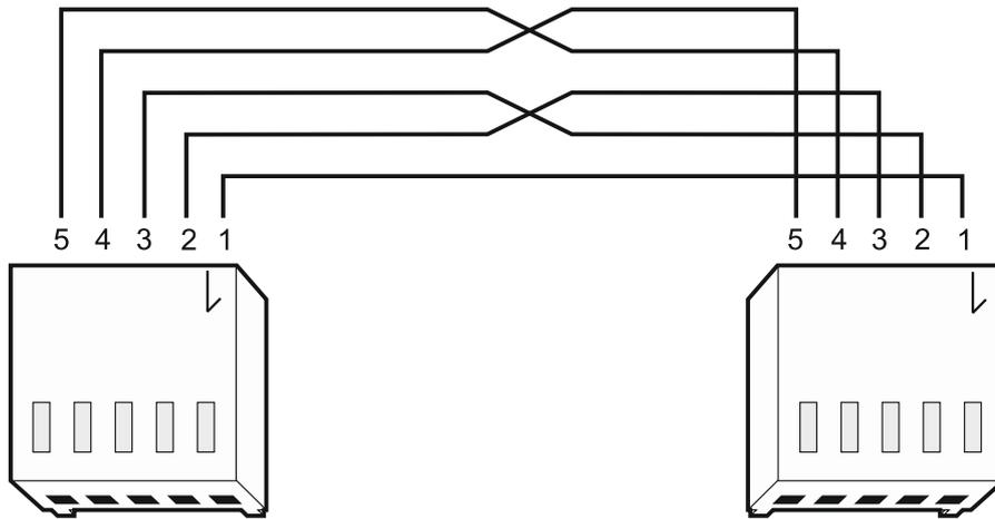
Рис. 3. Схема кабеля, предназначенного для подключения порта RS-232 модуля ETHM-1 Plus к порту прибора INTEGRA с разъемом PIN5.
