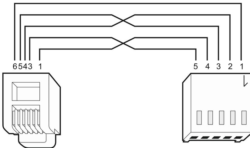
Рис. 4. Схема кабеля, предназначенного для соединения порта RS-232 модуля ETHM-1 Plus и прибора INTEGRA / INTEGRA Plus с разъемом типа RJ.
